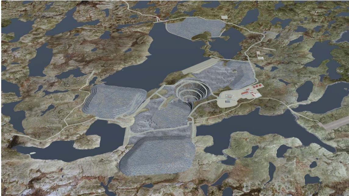
**Photo 5** Image de la fin des opérations minières présentant le remplissage des fosses et l'immersion et la fermeture de plusieurs zones
